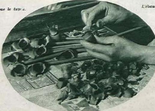
La pipe est débarrassée de toutes ses bavures.
